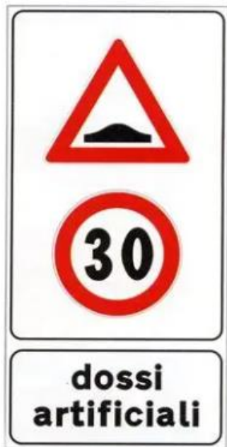
Fig.1: segnaletica presenza dosso
