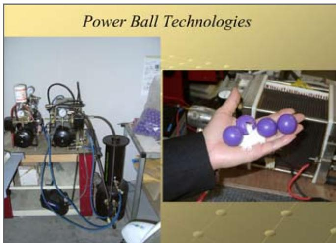
Vedete qui delle palline da ping-pong, all'interno hanno una polverina che è un idruro di sodio, praticamente il sale dell'acqua di mare. Questo viene trattenuto da una sfera, da una copertura di plastica perché se è a contatto con l'umidità
